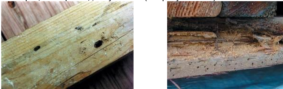
Рисунок 6.13. Древесная мука как результат деятельности насекомых-древоточцев
