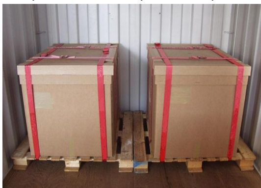
Рисунок 7.8. Груз, прочно закрепленный на поддонах найтовками из текстиля
