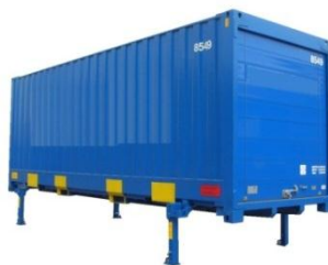
Рисунок 5.6. Съемный кузов, стоящий на опорах
