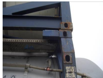
Рисунок 4.9. Уступ у вспомогательного бокового отверстия для подъема
