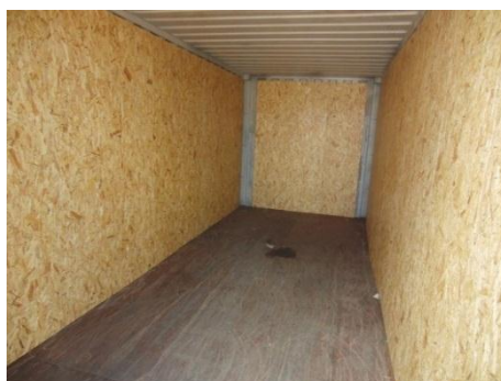
Рисунок 7.53. Облицовка 40-футового контейнера древесностружечными плитами
