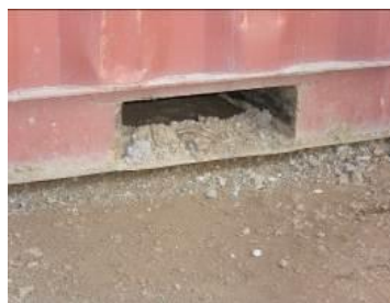
Рисунок 6.3. Грязь в кармане для вилочных автопогрузчиков
