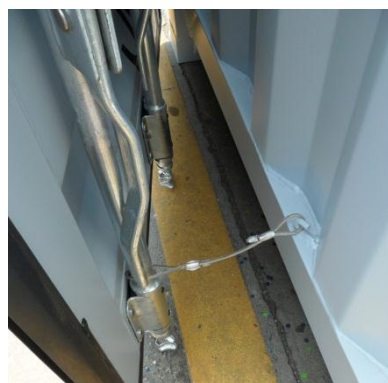
Рисунок 5.30. Фиксирующая лента двери
