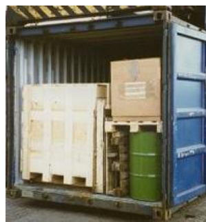
Рисунок 7.28. Смешанная укладка, использование поддонов
