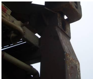
Рисунок 4.8. Уступ на верхнем фитинге
