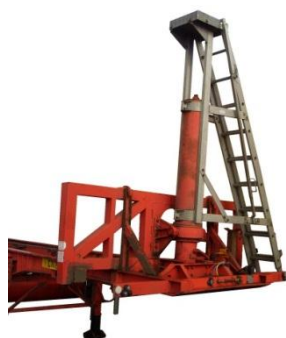
Рисунок 8.9. Установленная на трейлере лестница для доступа
