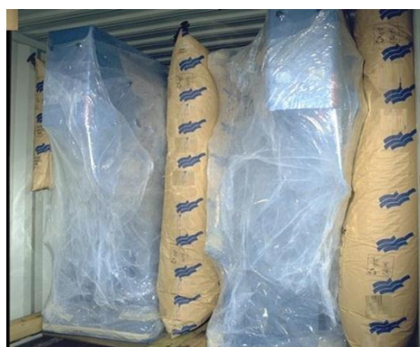
Рисунок 7.10. Блокировка пневмооболочками упаковок неправильной формы
