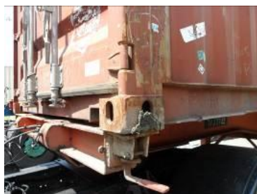
Рисунок 6.2. Грязь в угловом фитинге
