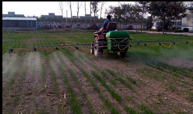
250L后置三角悬挂自走式喷杆喷雾机
